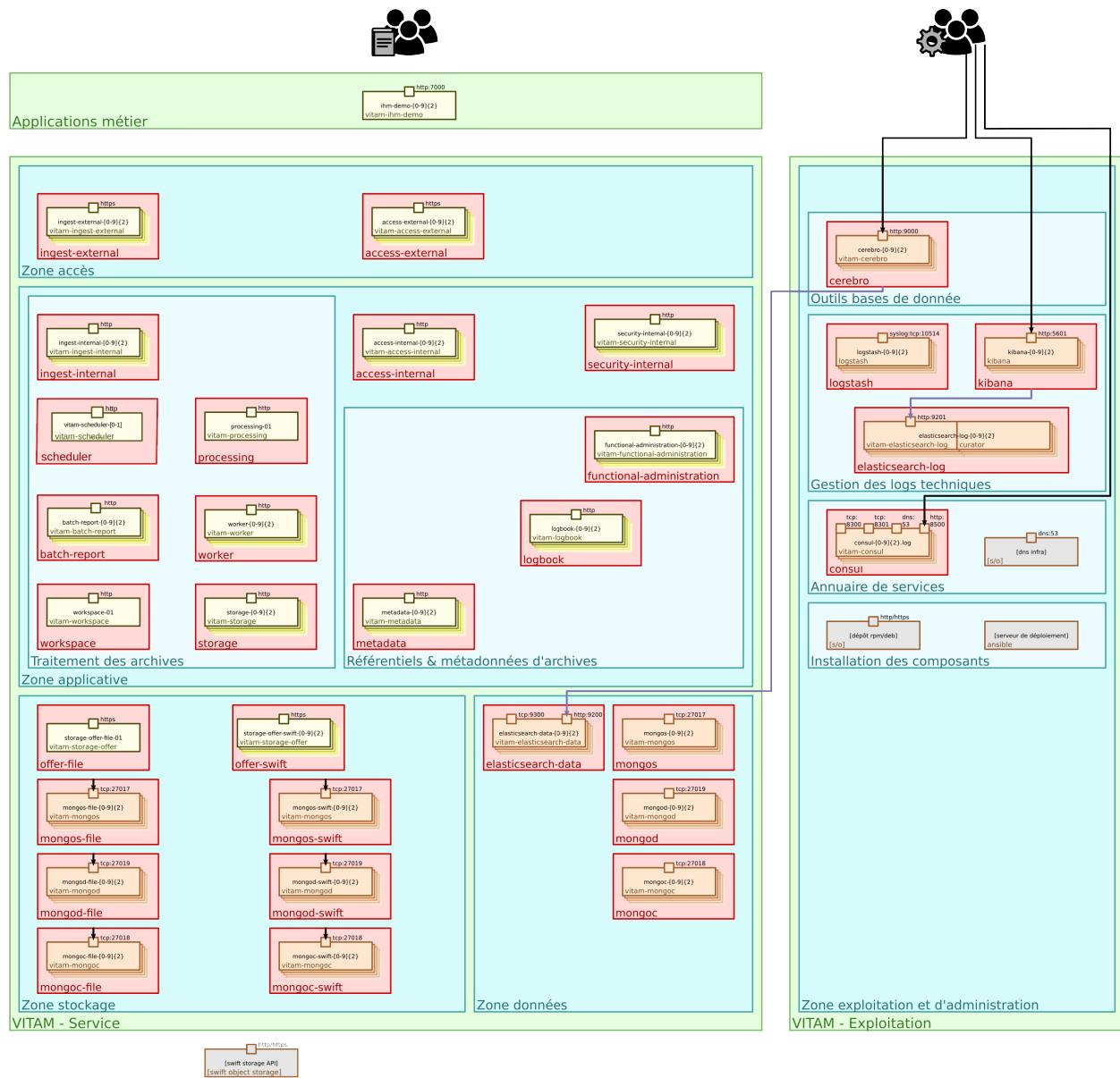
FIG. 1 – Vue d'ensemble d'un déploiement **VITAM** : zones, composants
